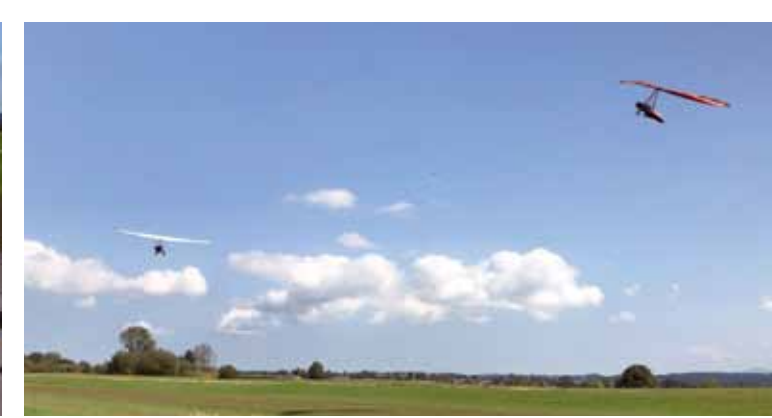
Mit 38 kW Startleistung zieht das Elektro-Trike den Drachen mühelos in die Luft.
